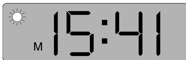
Рис. 3-5. Пример: экран ЖКД после успешного завершения самопроверки (M = данные АД в памяти, ☀ дневной режим измерений).
